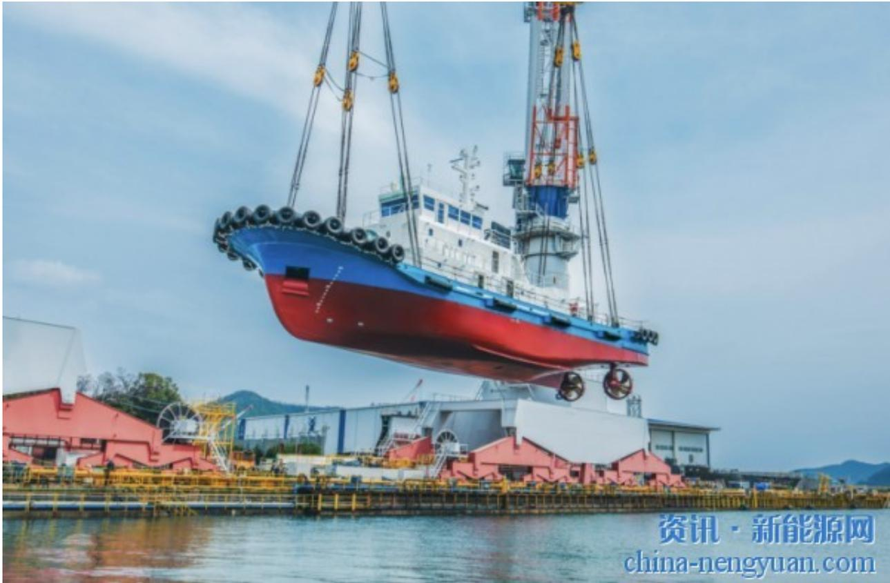
TSUNEISHI SHIPBUILDING在日本推出了日本第一艘配备氢动力内燃机（以下简称ICE）的拖船。该船于2025年3月28日在TSUNEISHI工厂下水。该船配备高功率输出氢双燃料ICE，并具有大容量和供应的高压氢气储存系统。它还使用JFE钢铁公司生产的“JGreeX”绿色钢作为其主体材料。通过使用绿色钢铁和氢燃料来减少对环境的影响，TSUNEISHI SHIPBUILDING将提供更清洁的船只，并为脱碳做出贡献。
